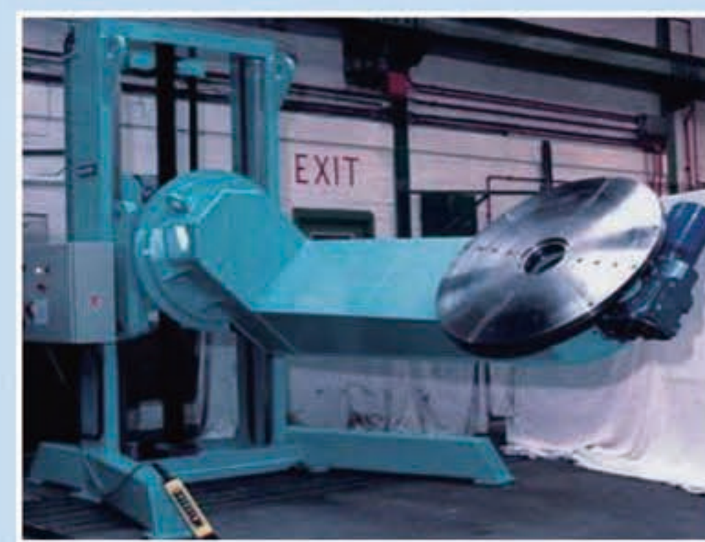
L型液压升降双回转变位机 L-type hydraulic double slew lifting positioner
